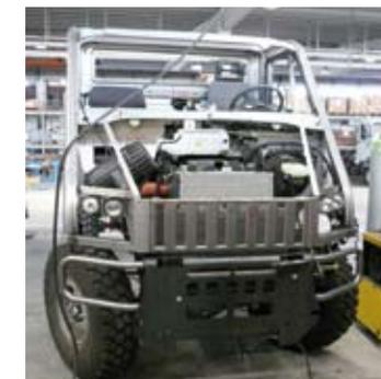
**BREMACH** ha realizzato una serie di modelli e prototipi al fine di verificare la validità del concept virtuale. Questo primo prototipo era infatti un modello statico, per lo studio di layout motore, ergonomia e vivibilità. Poi sono stati realizzati una serie di prototipi funzionanti, su cui sono stati provati diversi tipi di sospensioni, motori, tasselli etc.
