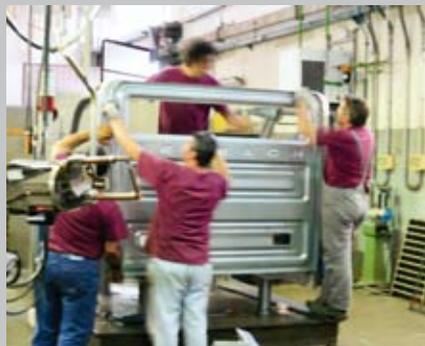
Il montaggio della cabina viene realizzato in un'officina specializzata per garantire la massima qualità dell'assemblaggio della struttura.
