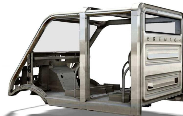
Il nuovo veicolo BREMACH è costruito con una cellula di struttura *space frame* modulare. Questa struttura nasce da profili tubulari che vengono lavorati in sezione in 3 dimensioni per creare un'architettura complessa dotata di una resistenza torsionale mai raggiunta su un veicolo di serie.
