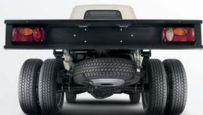
Porter Maxxi si caratterizza per la struttura con telaio rinforzato e ruote gemellate, garantendo così una maggior portata ed una superiore stabilità a pieno carico. Porter Maxxi è inoltre dotato di differenziale a slittamento limitato che consente una maggior aderenza in situazioni d'uso particolarmente difficili.
