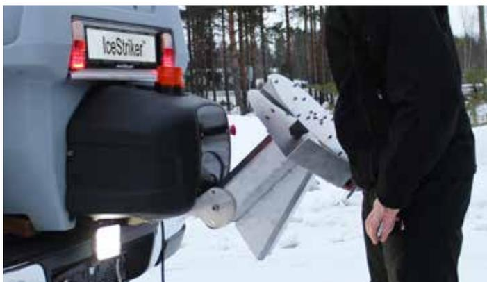
Scivolo ribaltabile in acciaio inox. Progettato per spargere sale con elevata umidità.
